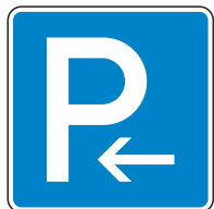
Zeichen 314-10 Format in mm 420 x 420 Parken Anfang 600 x 600 (Aufstellung rechts) 840 x 840 Parken Ende (Aufstellung links)
