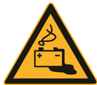
Warnung vor Gefahren durch das Auslaufen von Batterien (W026) ISO 7010, ASR A1.3
