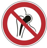
Kein Zutritt für Personen mit Implantaten aus Metall (P014) ISO 7010, ASR A1.3
